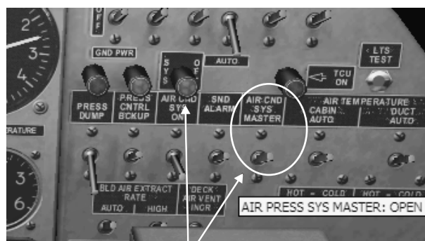
Air pressurization system ON. Red light off СРД включена. Красный сигнализатор погас.
