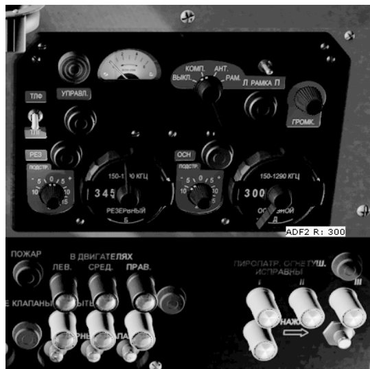
1. Set frequency on ADF-2 Ставим частоту на АРК-2
