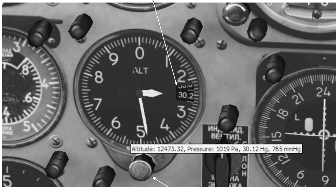
Baro pressure knob on copilot's altimeter Рукоятка барометрического давл. на высотометре ВП
