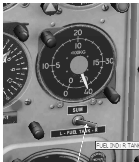
Check fuel L/R Tanks and SUM Проверить уровень топлива в баках (нет ли разницы)
