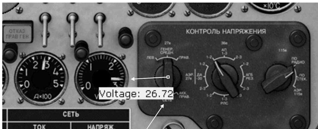
Monitor main 27V bus voltage Контроль напряжения сети 27В
