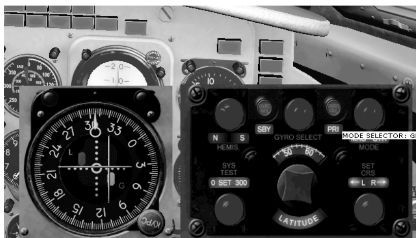
Perform magnetic correction of course system Провести магнитную коррекцию курсовой системы
