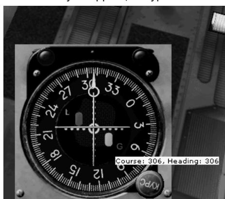
Keep localizer's needle inside the circle of gyro course needle Держать курсовую планку внутри кружка стрелки гирокурса
