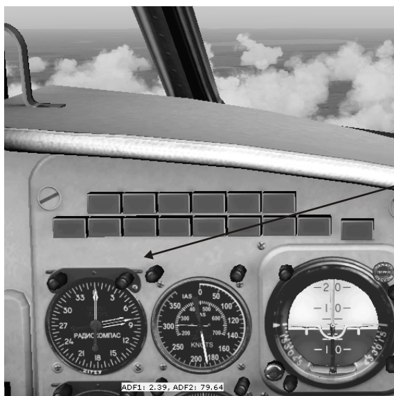
1. Set frequency on ADF-2 Ставим частоту на АРК-2
