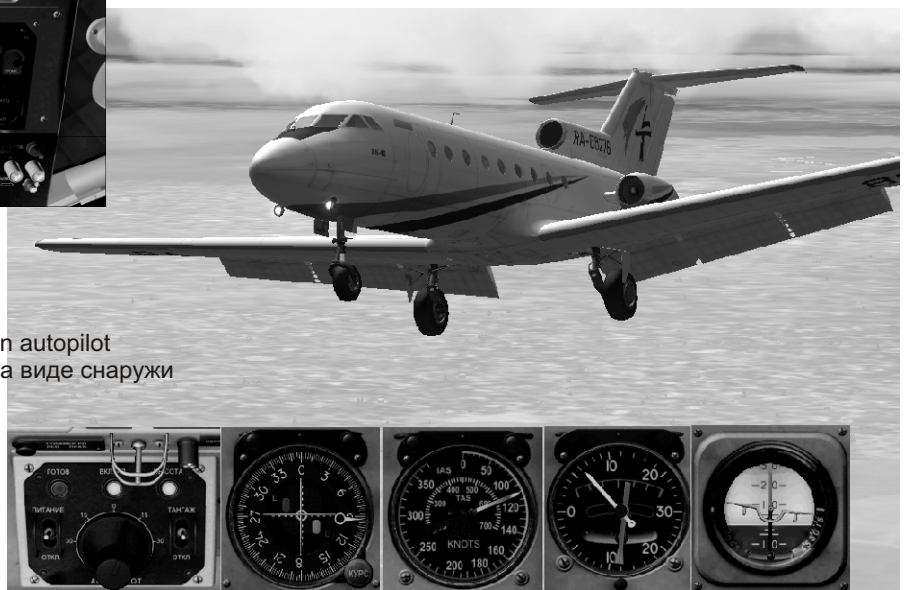
Tune ADF radios and check needles response Контроль реакции стрелок при настройке АРК
