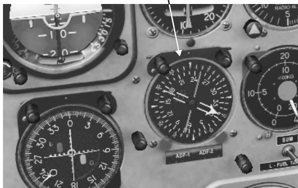
Captain's dual needle RMI (IKU) Двухстрелочный указатель КВС (ИКУ)
