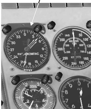
Copilot's ADF indicator Указатель АРК ВП
