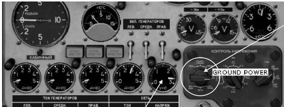
Electrical system controls on the bottom of the main copilot's panel Щиток контроля напряжений в нижней части основной панели ВП
