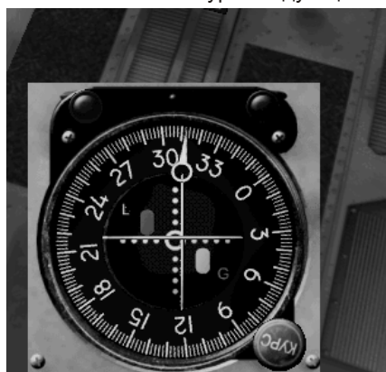
Aim circle of heading needle to localizer needle "Взять в прицел" курсовую планку
